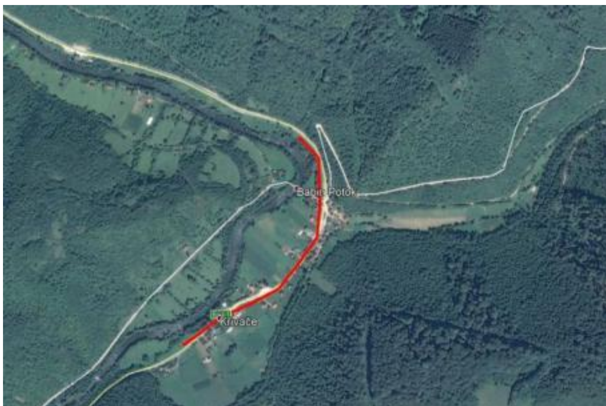
Slika 19: 3. Projektni potez, Rekonstrukcija ceste sa korekcijom ose na stacionaži 19+778.1-20+678.5
