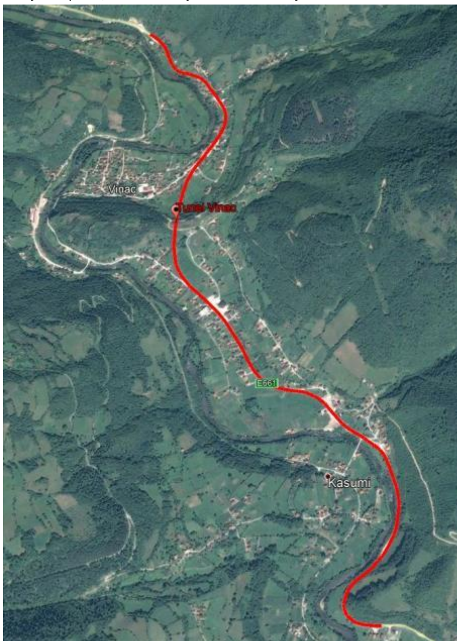
Slika 17: 1. Projektni potez, Rekonstrukcija ceste sa korekcijom ose na stacionaži 10+400-13+900
